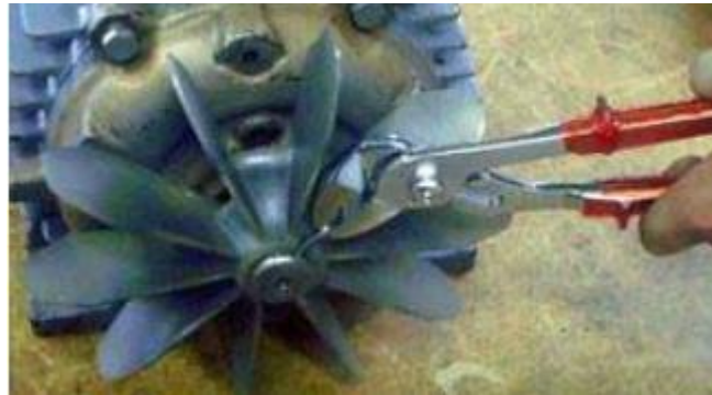
شكل رقم ٤٧: سحب خابور التثبيت
