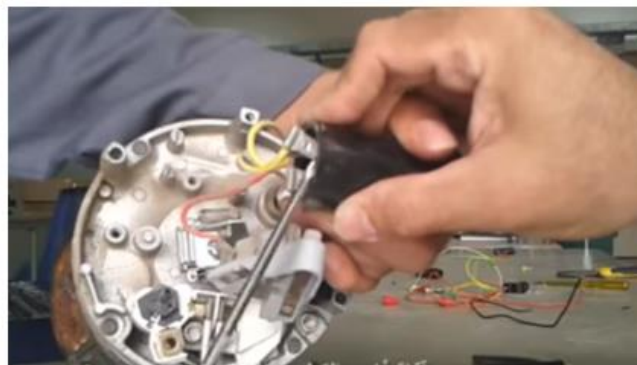
شكل رقم ٦٠: فك الموصلات من المكثف
