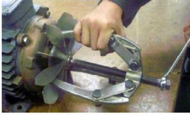
شكل رقم ٤٨: فك المروحة بالزرجينة
