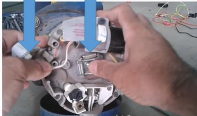
شكل رقم ٥٥: الجزء الميكانيكي لمفتاح الطرد المركزي
