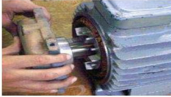
شكل رقم ٤٩: سحب العضو الدوار
