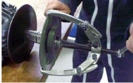
شكل رقم ٤٣: سحب البكرة باستخدام الزرجينة
