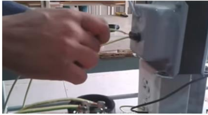
شكل رقم ٦١: اختبار المكثف بتوصيله بجهد متردد ٢٢٠ فولت
