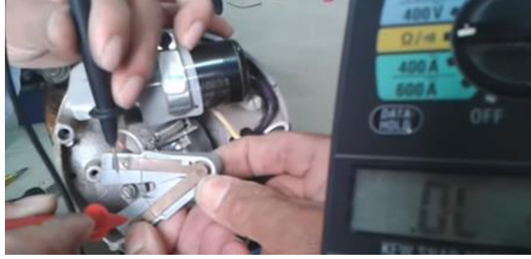
شكل رقم ٥٦: اختبار نقاط تلامس المفتاح
